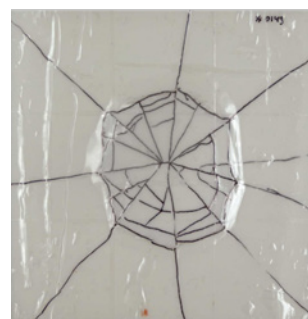
Martin Fonnum Jakobsen forsker på hvordan skuddsikre plater kan bli mer solide. Til høyre er ser vi sprekkdannelser på forsiden og baksiden av en av platene som er testet i forsøkene. Foto: FFI
